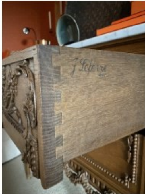
Fig. 7. Greet Lefèvre, Zwaluwstaartverbinding in commode van Kammeubelen Lefèvre, 2023, kleurfoto, 10 x 15 cm, privécollectie Greet Lefèvre.
