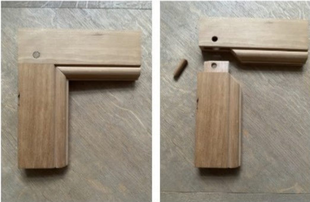
Fig. 5. Greet Lefèvre, Verduidelijng pen-en gatverbinding (gesloten), 2023, kleurfoto, 10 x 15 cm, privécollectie Greet Lefèvre.
